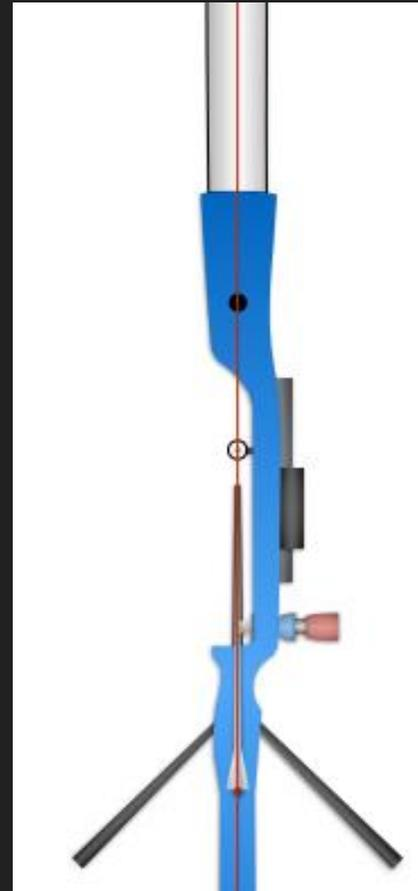
Pour ce qui est de la flèche, elle doit être alignée entre  $\frac{1}{2}$  pointe à l'extérieur et dans l'axe de la corde
